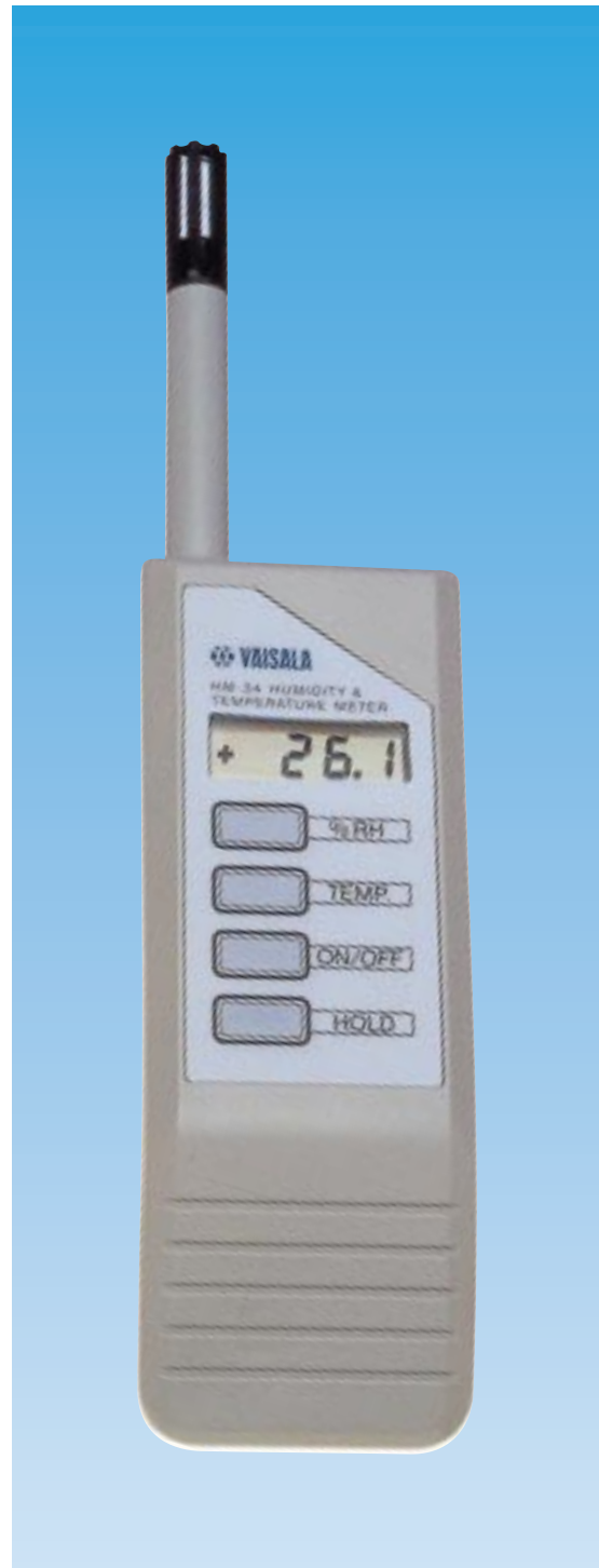
HM34 on kätevä, nopea ja tarkka ilman kosteuden ja lämpötilan mittauksissa
