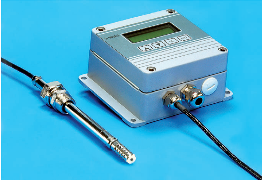
Der Vaisala HUMICAP® Ölfeuchte- und Temperaturmesswertgeber HMP228 ermöglicht eine kontinuierliche Ölfeuchteüberwachung selbst unter anspruchsvollen Prozessbedingungen.
