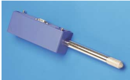
Sonde HMP361 avec filtre inox fritté.
