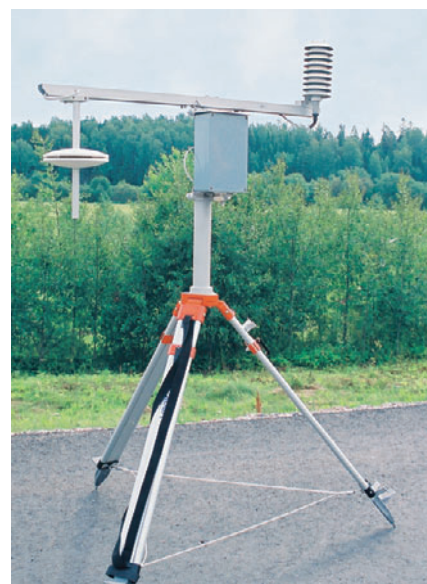
Installationssatz PTU200MIK1 mit Strahlungsschutz und statischem Druckkopf montiert auf Dreibeinstativ PTU200TRIPOD für mobile Außenmessungen
